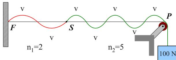
Esquema de las ondas estacionarias en los hilos.
